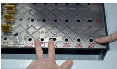
*I pezzi in lavorazione vengono posizionati su un apposito tavolo di supporto con dei perni; tuttavia possono essere utilizzate anche piastre strutturali di produzione propria.*
